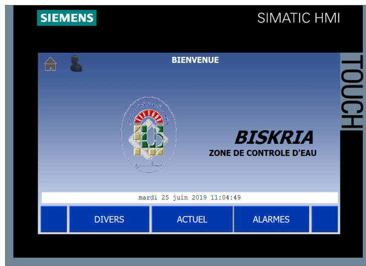
Fig.4.31 : Vue principale de l'HMI
