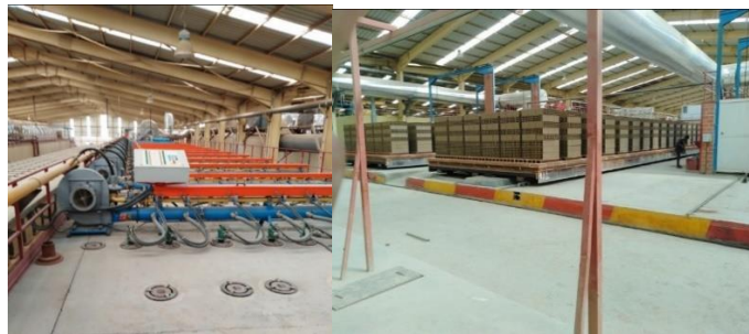
Fig. 1.7 : Entrée de briques préparées au four.
