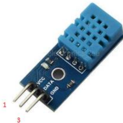
Figure III.10 : Capteur de température et d'humidité de l'air(DHT11)
