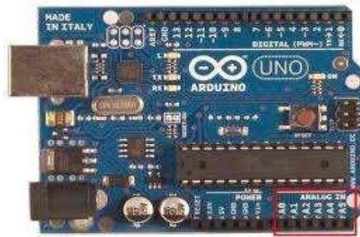
Figure III.3 : Les Broches d'entrées Analogiques.
