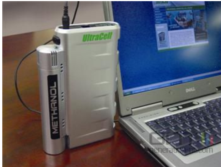
Fig 1.5: Pile à combustible au méthanol Ultracell
