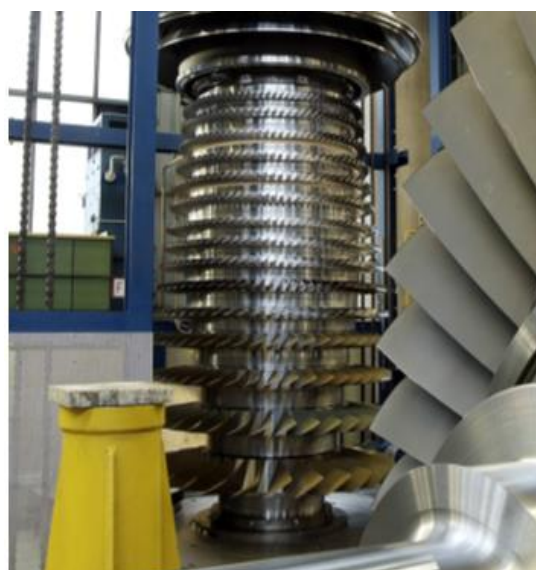
Figure I-12: Le Compresseur (15 étages).
