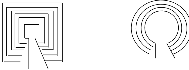
Figure I.1 Géométrie des inducteurs d'une cuisson à induction
