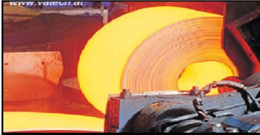
Figure III.4: Laminage à chaud des tôles [21].
