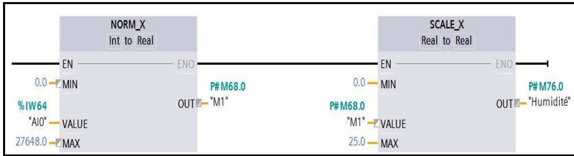
Figure III.17 : Mise à l'échelle d'entrée analogique (capteur de l'humidité).
