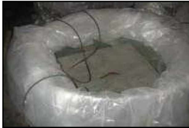
Figure I.19: Cube de 0,6m de côté dans de l'eau saturée en chaux [30].
