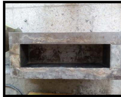
Photo III.2: moule pour éprouvette prismatique (10×10×40)
