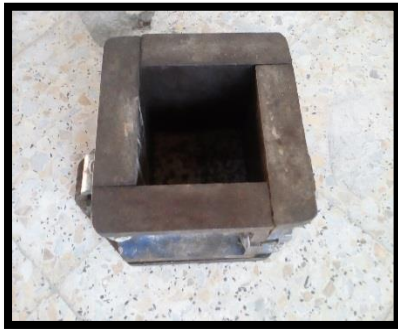
Photo III.1: moule pour éprouvette Cubique (10×10×10)
