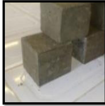
Photo III.5 : Éprouvettes cubiques (10x10x10) cm 3
