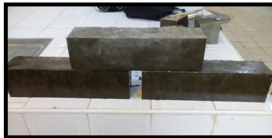
Photo III.6 : Éprouvettes prismatique (40 x 10 x 10) cm 3
