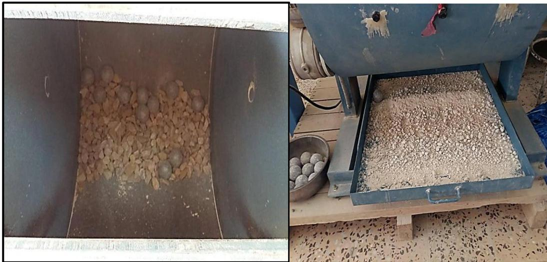
**Figure 14 :** Matériel de l'essai de fragmentation (Los Angeles)
