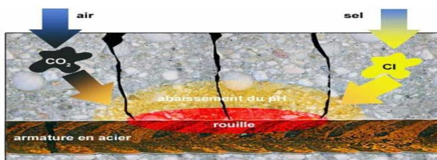
**Figure 21** : Principe de corrosion des armatures
