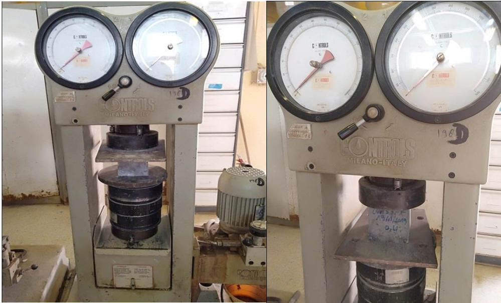
**Figure 33** : Essai de résistance à la compression
