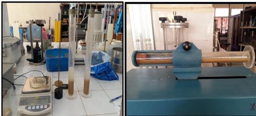
**Figure 12** : Matériel de l'essai équivalent sable
