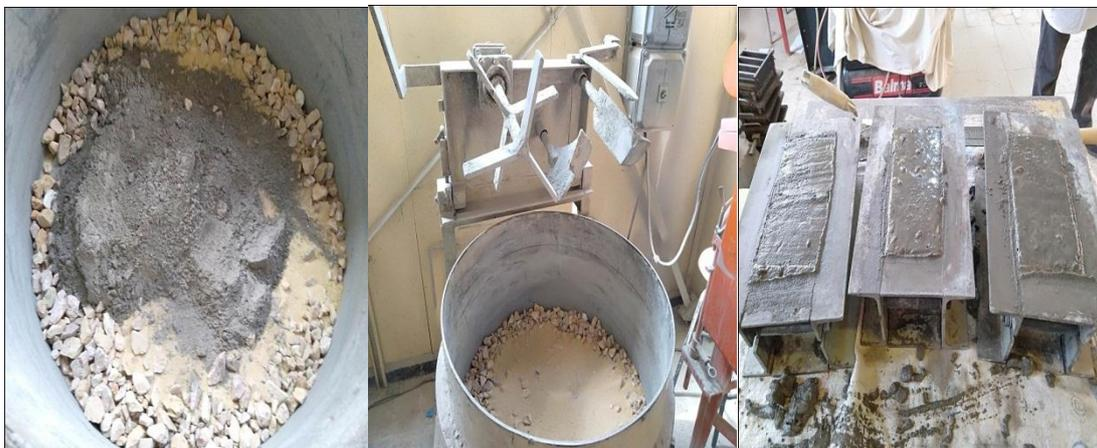
**Figure 18 :** Procédure de confection du béton au labo
