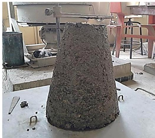
**Figure 30: Essai d'affaissement**
