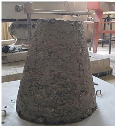
**Figure 37 :** Essai d'affaissement du béton
