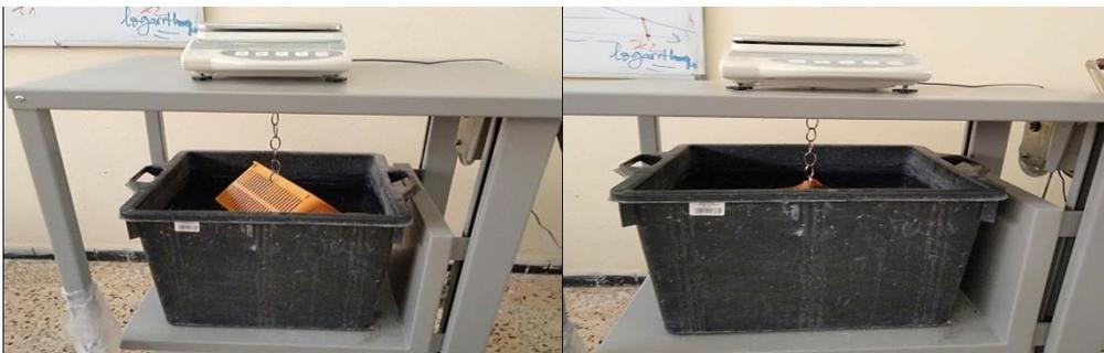
**Figure 34:** Pèse hydrostatique
