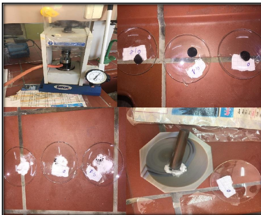
Figure III.5 : Préparation de poudre et des pastilles.
