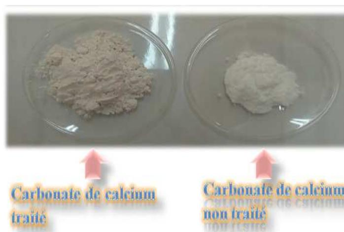
**Figure III. 3:** Carbonate de calcium traité superficiellement et non traité.
