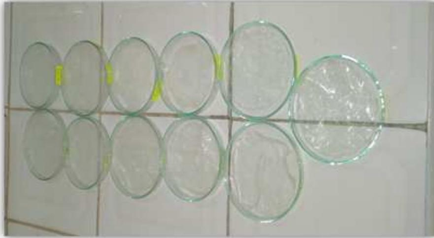
**Figure III. 13 :** Biopolymères à base de l'amidon/ $\text{CaCO}_3$  obtenus.
