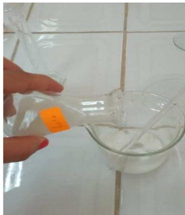
**Figure III. 12** : Préparation des films bioplastiques amidon / $\text{CaCO}_3$
