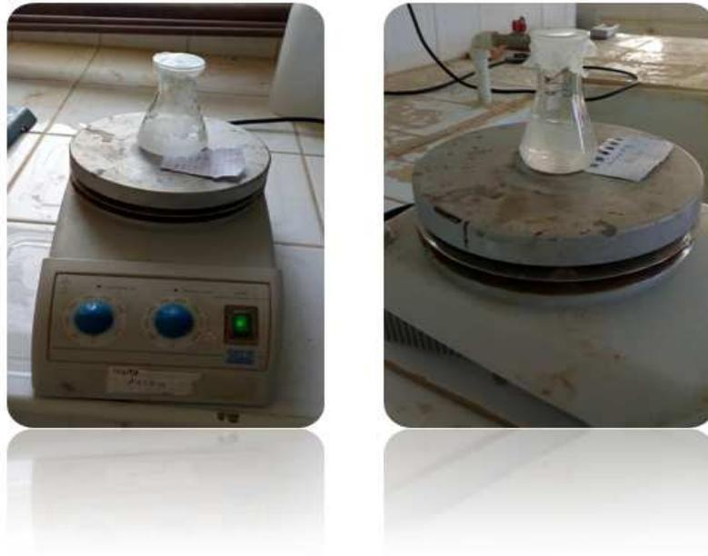
**Figure III.11** : Préparation d'une solution de  $\text{CaCO}_3$ /eau distillé
