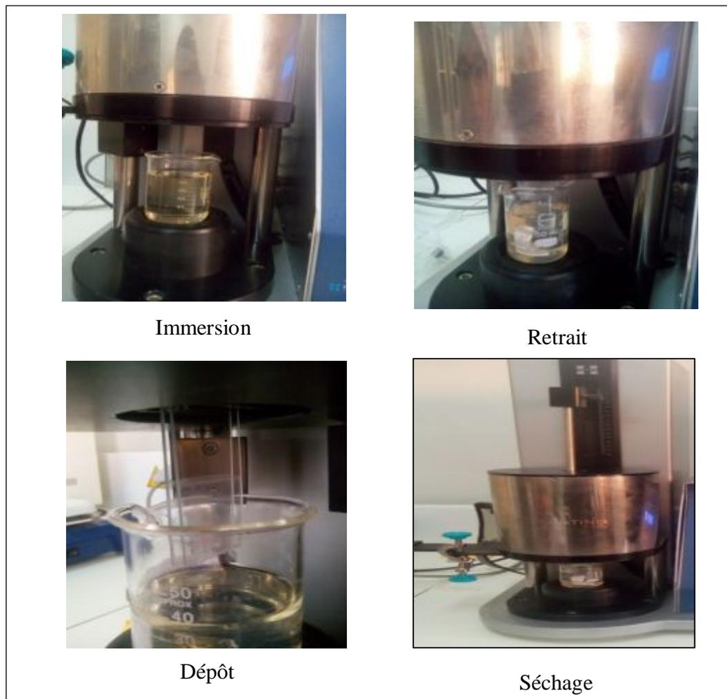
**Figure III.7** : Le principe du trempage –retrait (dip-coating).
