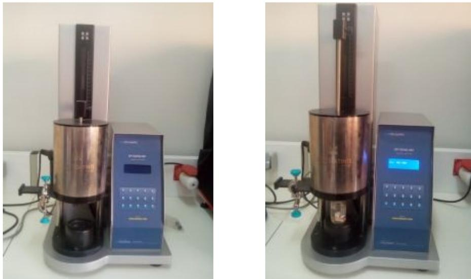
**Figure III.5** : Dispositif expérimental de dépôt dip coating model HO-TH-02B avant et après le démarrage.
