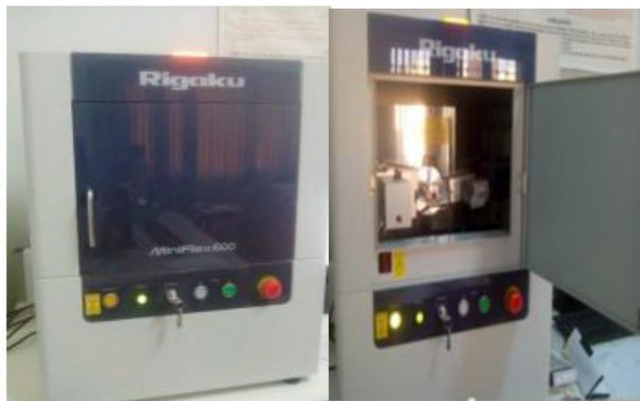
**Figure III.11 :** l'appareil de diffractomètre du type Rigaku Miniflex 600 X
