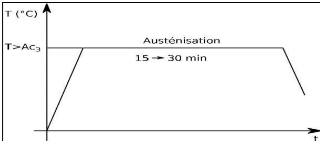
Figure II.1: Le cycle de la trempe. [20]
