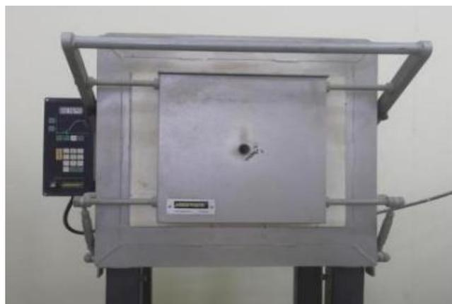
**Figure III.5:**four électrique type de Nabertherm D-2804.
