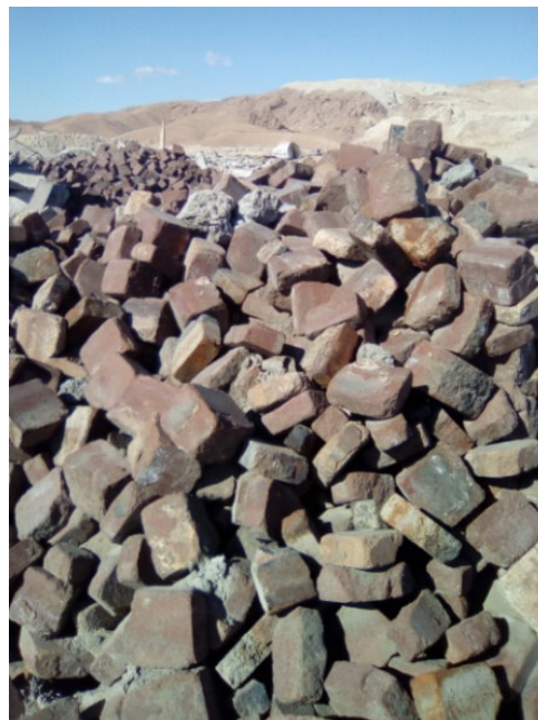
Figure II.2. Déchets de four briques réfractaires.
