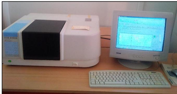
**Figure III.2** : Spectroscopie IRTF.
