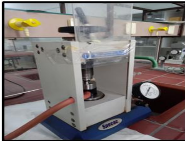
Figure III-10: Presse hydraulique pour former l'échantillon en forme de pastille.
