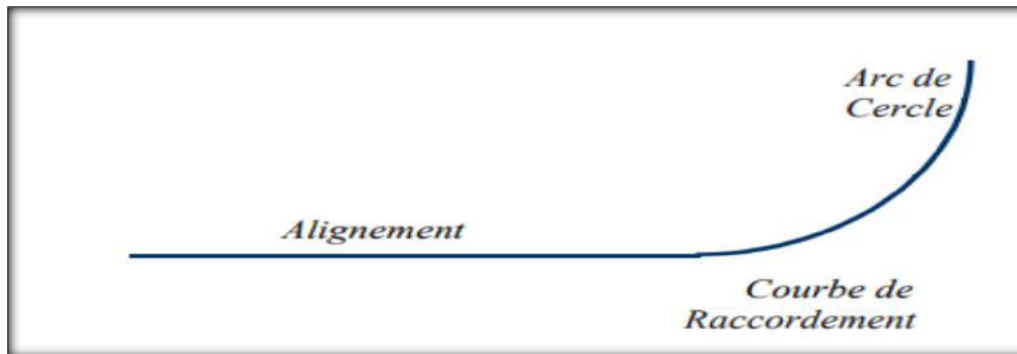
Figure IV.1 : Les éléments du tracé en plan
