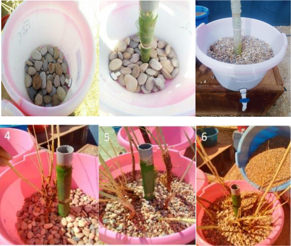
الشكل 25: صور توضيحية لعملية لمراحل ملئ الاحواض
