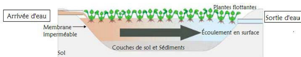
Figure 1.1 : Représentation schématique d'un marais filtrant à écoulement sur la surface avec plantes flottantes (Gagnon et al, 2013).
