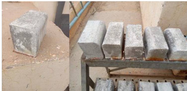
Figure I.40 Blocs fusibles à arête amont arrondie
