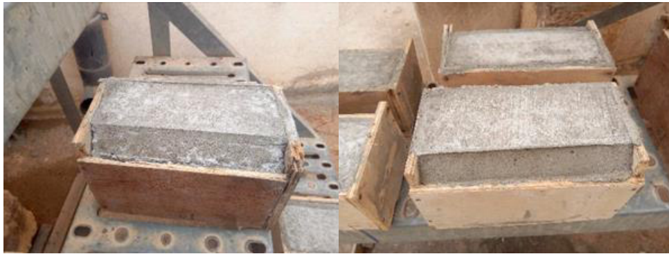
Figure I.39 Blocs fusibles à arête amont chanfreinée
