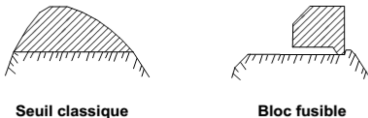
Figure I.30 Bloc fusible placé sur un seuil après un arasement
