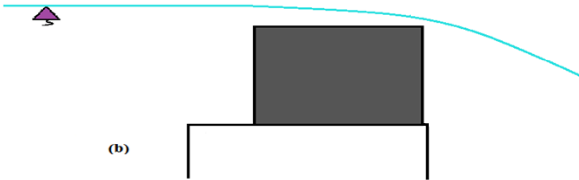
Figure II.5.b Bloc fusible fonctionne comme un déversoir
