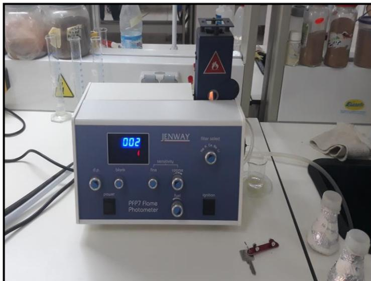
Figure 35 : Photomètre de flamme industriel PFP7 – Jenway et mode d’emploi (2019)
