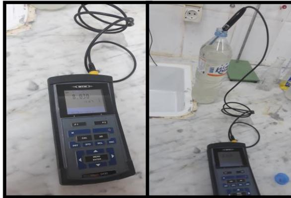
Figure 28: WTW-Lab.-pH-Portable\_meters fonction de mesure pour la mesure portable sur le terrain et pendant le fonctionnement(2019)
