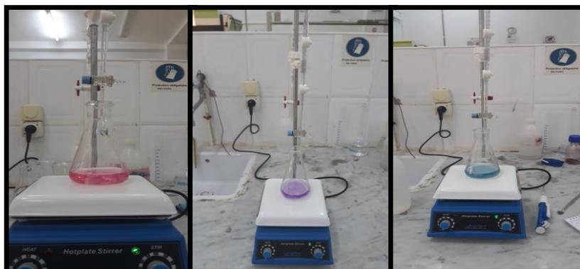
Figure 30: Calibrer Titre hydrométrique (TH) dans un laboratoire (2019)
