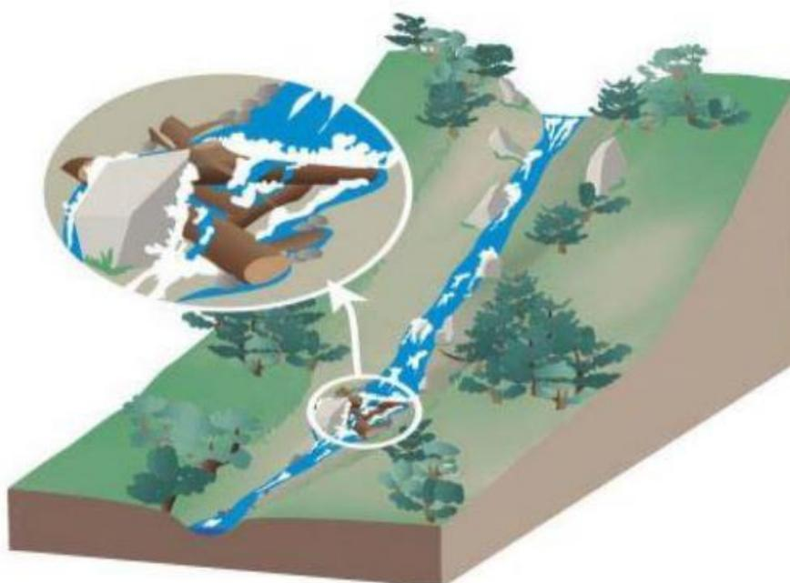
**Figure I.04 :** Embâcle sur un torrent, inondation par crue torrentielle
