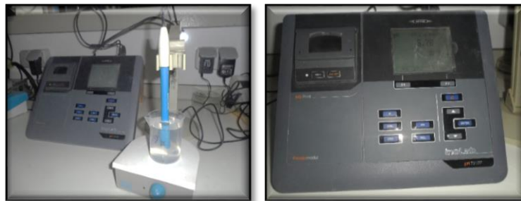
Figure 39 : pH mètre utilisé au cours des essais.
