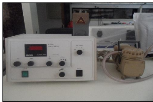
Figure 43: Spectrophotomètre à flamme utilisé pour le dosage du sodium et du potassium.
