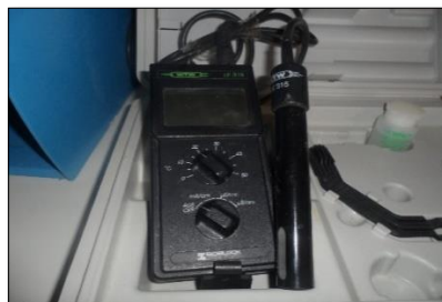
Figure 40: Conductimètre utilisé pour la mesure de la conductivité des échantillons d'eau
