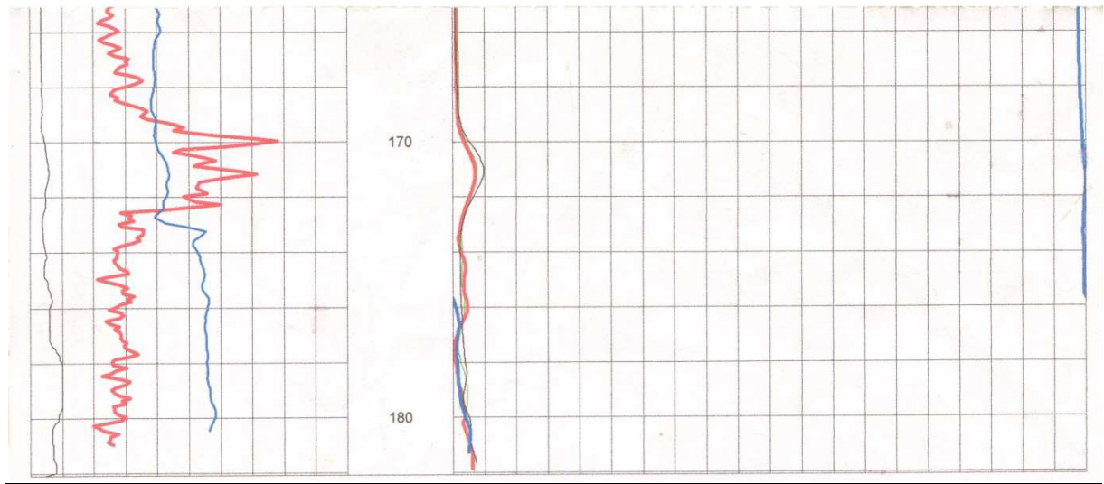
Figure 27 : Résultat du diagraphie de forage de Ouled Thamen « 02 »[3]
