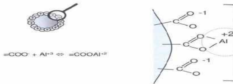
Figure II. 4 : Représentation schématique de neutralisation des charges. (Ezziane, 2007)
