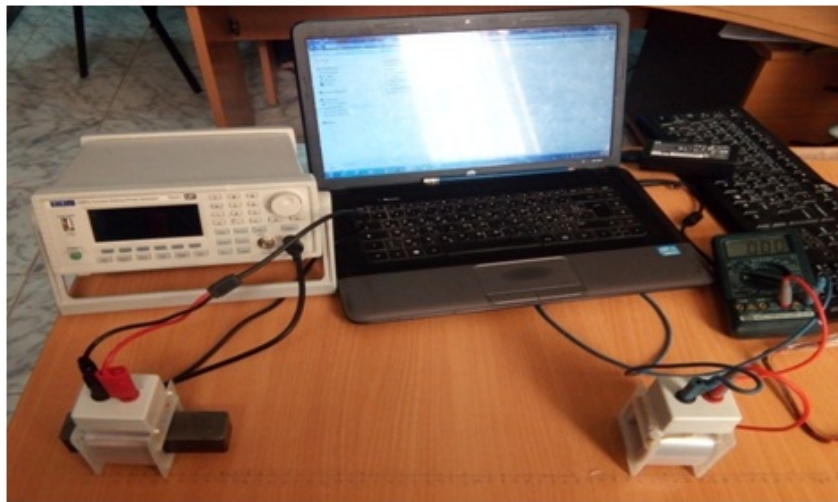
Fig 2.11: montage réalisé avec barreau magnétique au niveau de la bobine émettrice .
