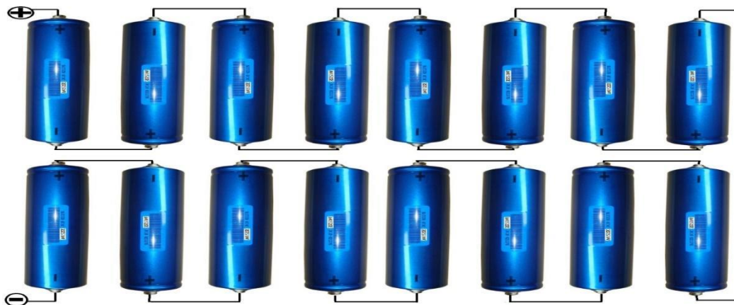
Fig. 3.3 : La mise en série de 16 cellules LiFePO4 38120S.
