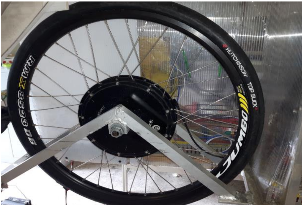
Fig. 3.9 : photo réel de moteur installé dans le prototype.
