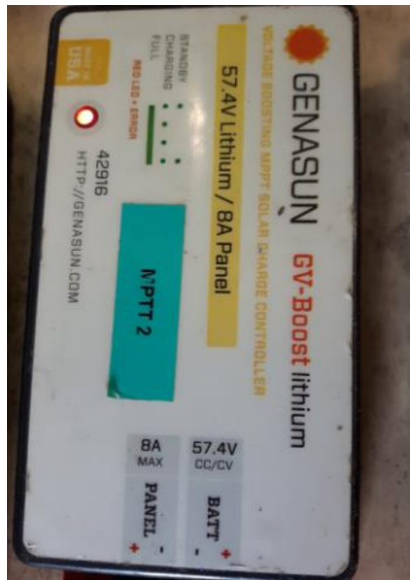
Fig. 3.13 : Photo réel de MPPT installé dans le prototype.
