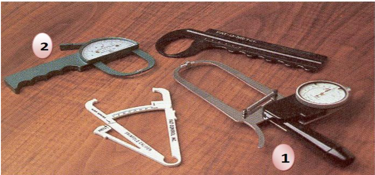
شكل (06): أنواع مختلفة من مقاييس سمك طية الجلد، ويظهر نوع هاريندن رقم (1) وكذلك نوع لانج رقم (2) (بن شعيب، 2014، صفحة 49)
