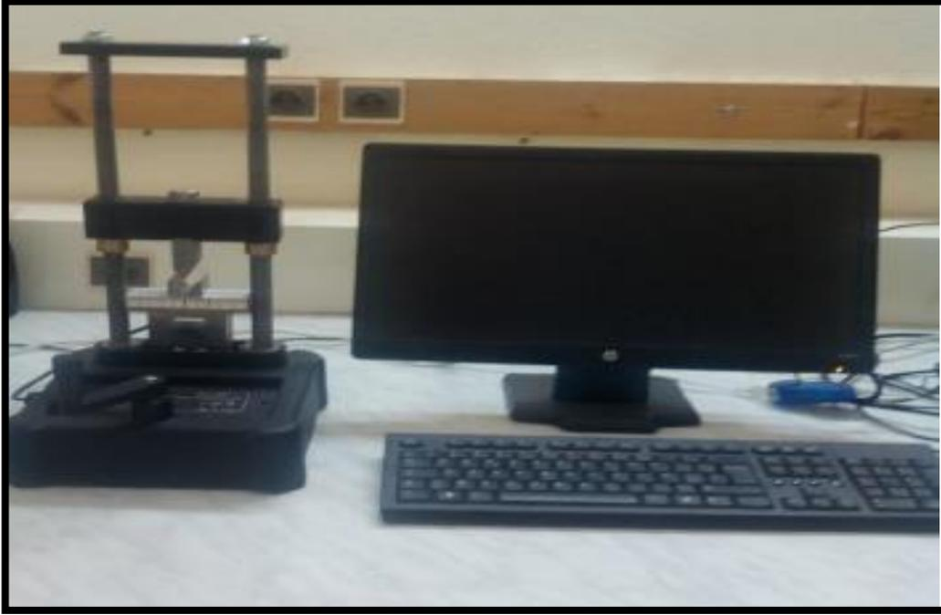
الشكل (III-6): صورة لجهاز إختبار الثني.
