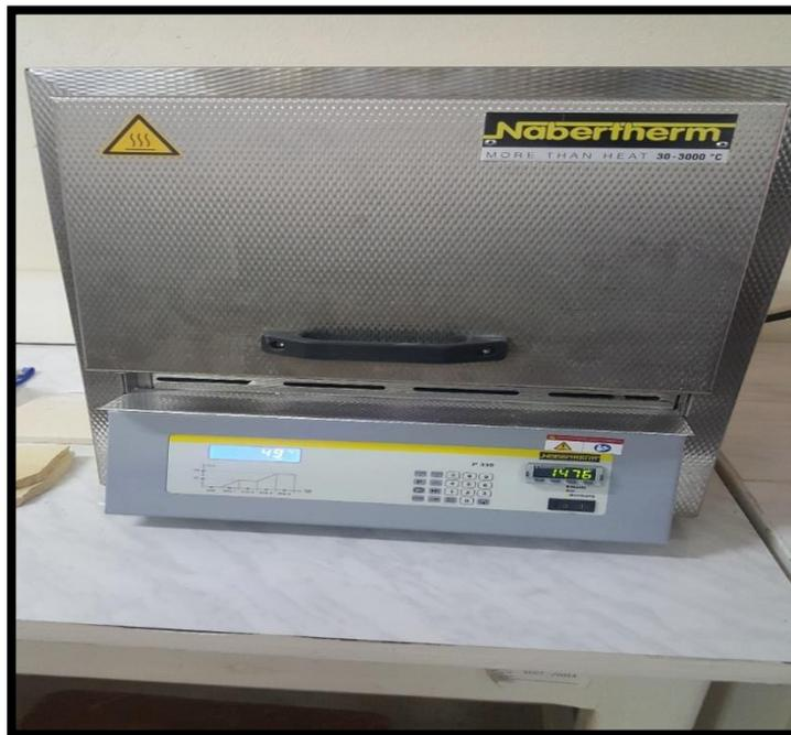
الشكل ( II-17): صورة للفرن الكهربائي.
