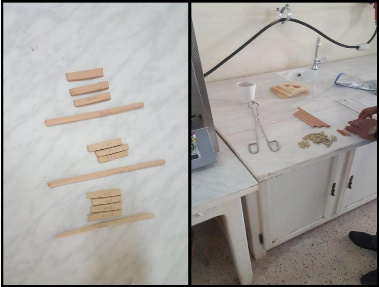
الشكل ( II-16): صور لبعض العينات من الحوامل بعد المعالجة الحرارية ( $1000^{\circ}\text{C}$  -  $1100^{\circ}\text{C}$ ).
