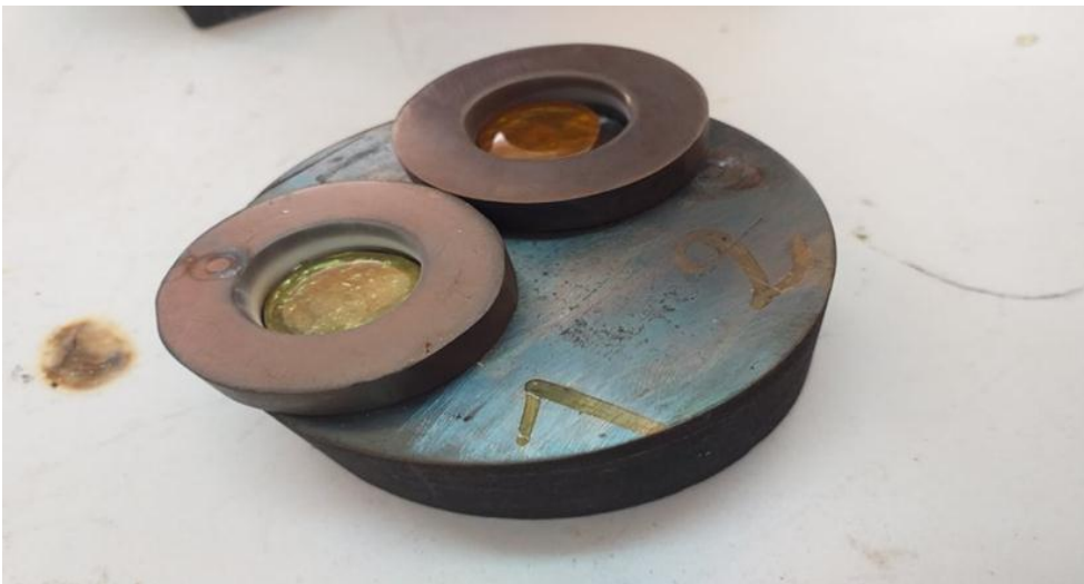
الشكل (II-5): صورة فوتوغرافية توضح عينات الزجاج بعد اخراجهم من الفرن.
