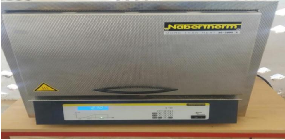
الشكل (II-4): صورة فوتوغرافية من NABERTHERM (Tmax 1300°C).
