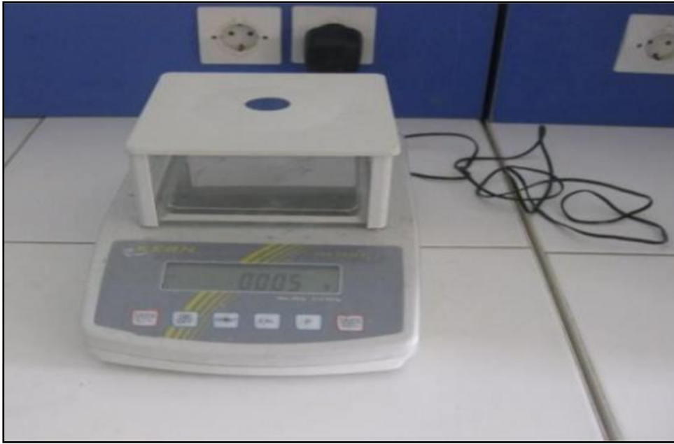
الشكل (II-2) : ميزان نوع Balance KERN PLS360-3 .
