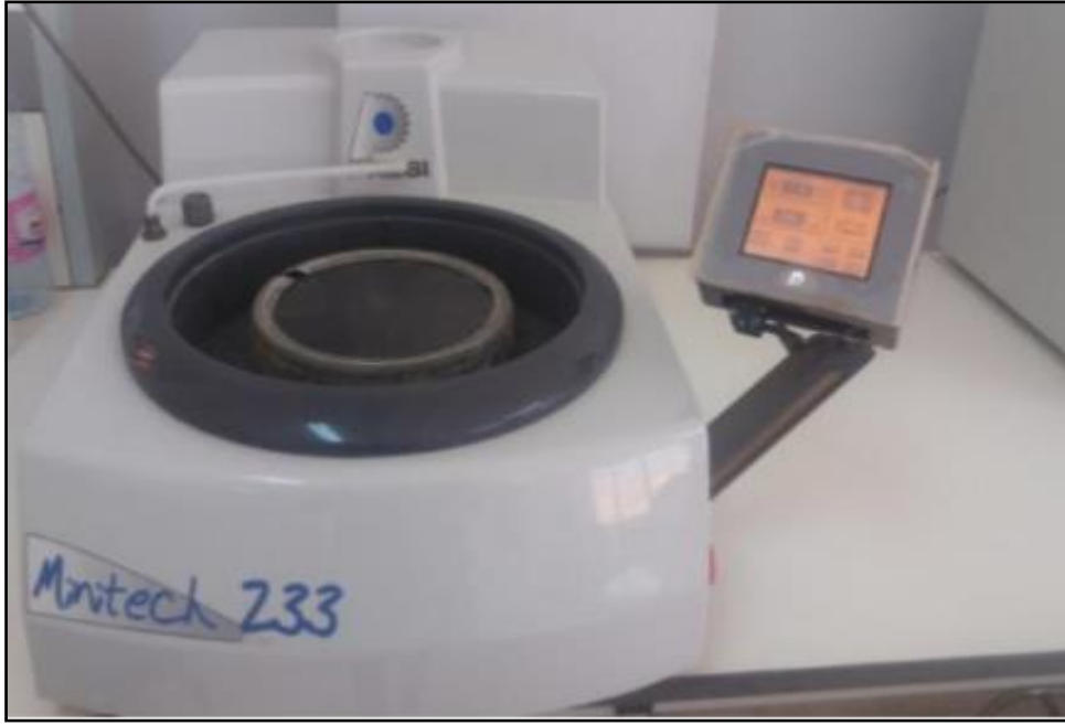
الشكل (II-6) : آلة الصقل نوع Minitech 233Megapol pressi .
