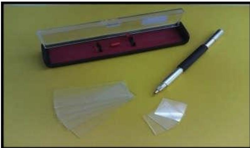
**Figure II.2:**Substrats en verre et stylo à pointe en diamant.
