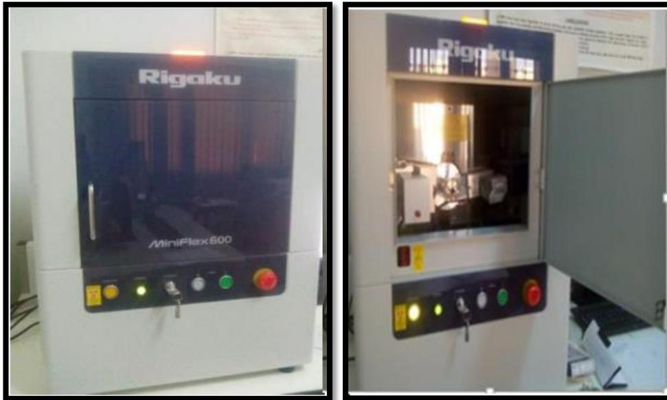
**Figure III .14.** L'appareil de diffractomètre du type Rigaku Miniflex 600 X.
