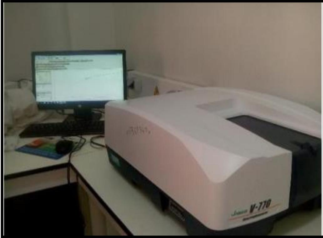
**Figure III.20** : Le spectrophotomètre V-770.
