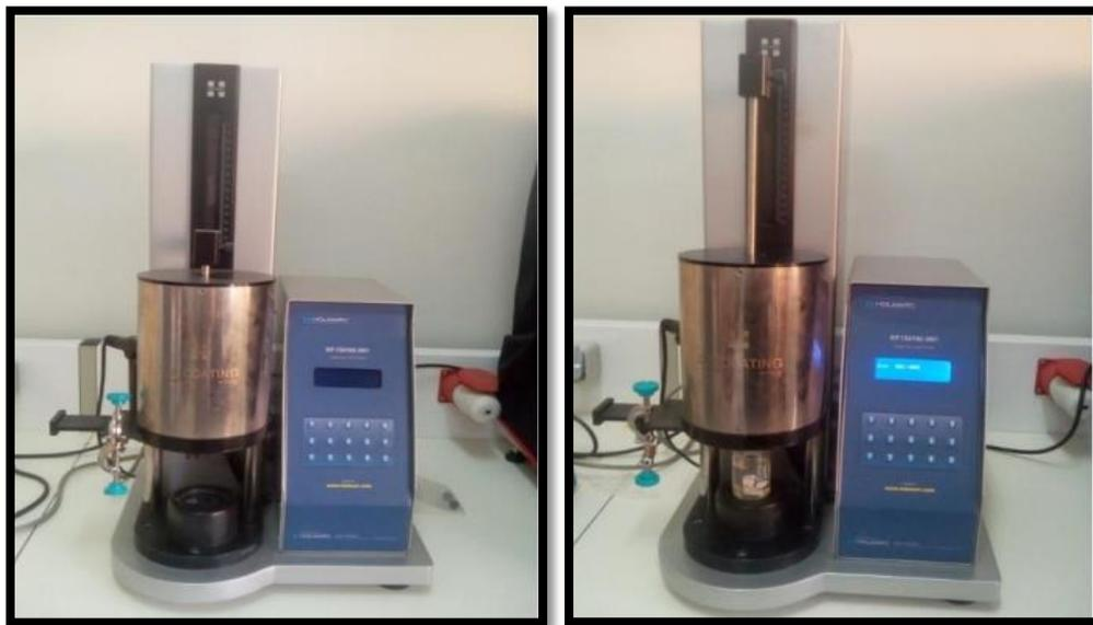
**Figure III.7 :** Dispositif expérimental de dépôt dip-coating model HO-TH-02B avant et après le démarrage.
