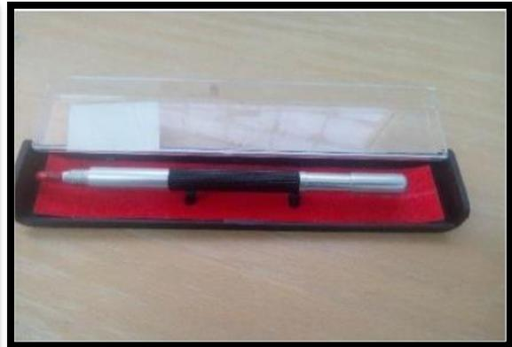
Figure III.2 : le stylo à diamant.
