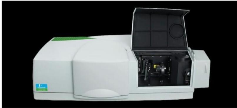
**Figure II-16:** L'appareil de type Perkin-Elmer pour la spectroscopie UV.
