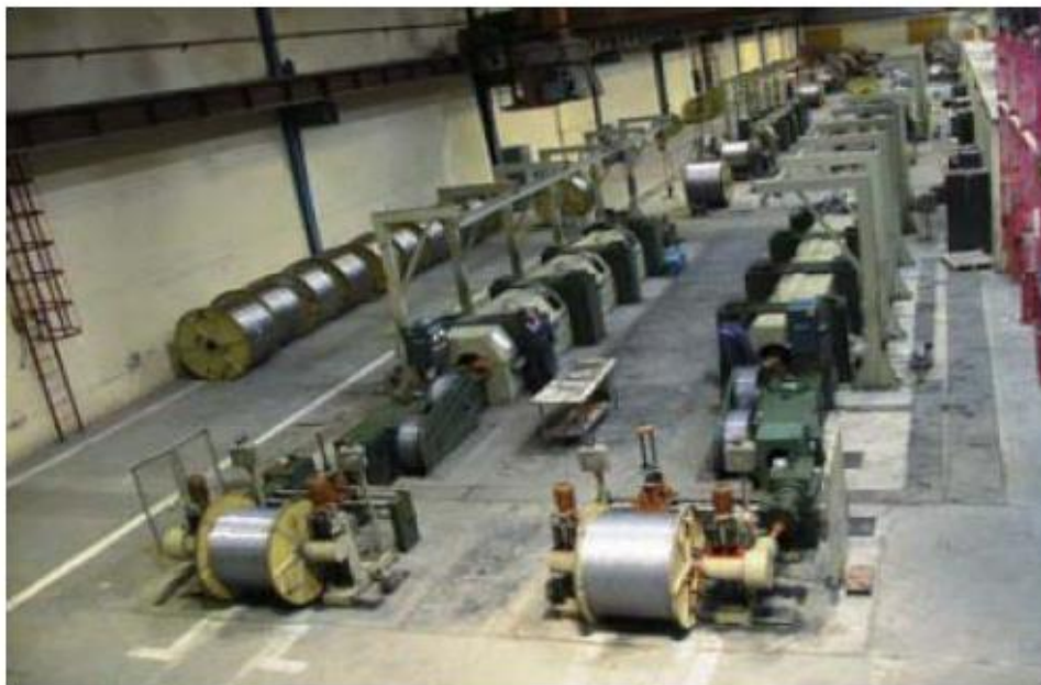
Figure I.3 : Lignes de tréfileuses pour Aluminium à L'ENICAB Biskra
