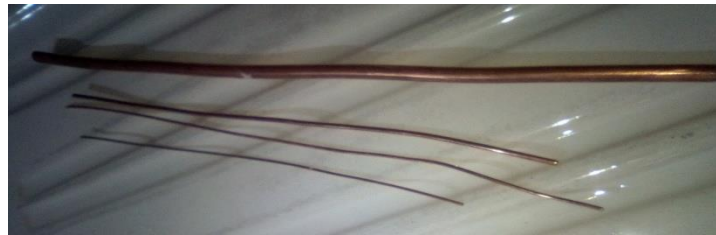
Figure II.1: Fil machine et fils tréfilés de cuivre étudiés
