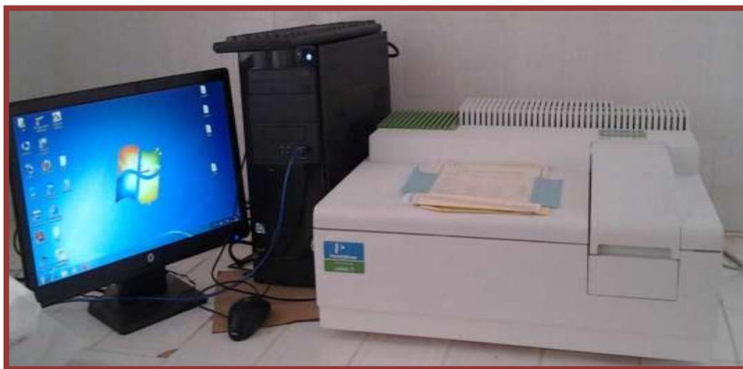
**Figure (II.20):** ultraviolet-visible spectrophotometer (LAMBDA 25).
