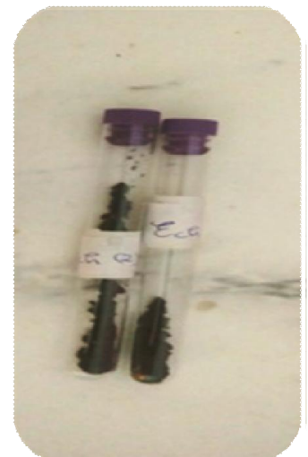
5. Le produit obtenu après 5 la calcination à 750°C
