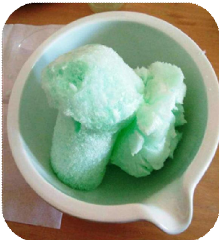
4. Le précurseur obtenu après le séchage à 100°C
