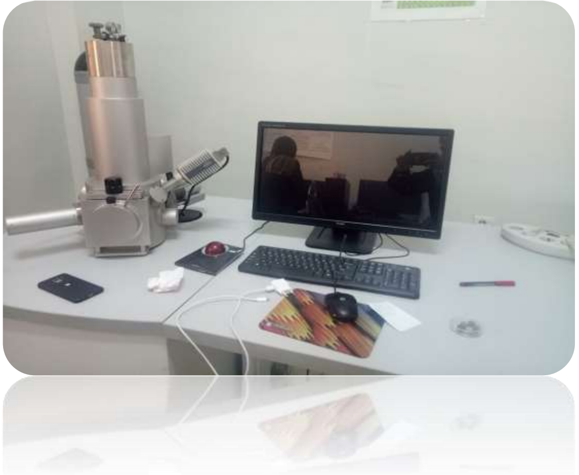
Figure II.8: Microscope électronique à balayage JEOL JSM.6390L
