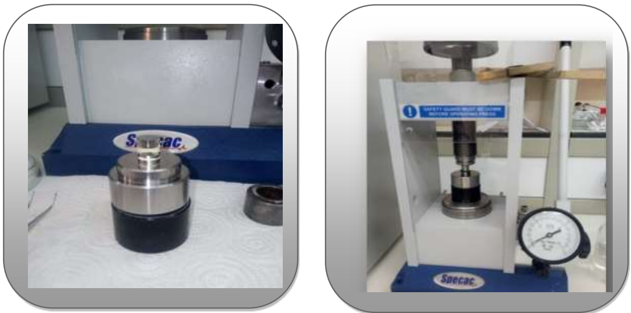
Figure II.6: La presse hydrostatique utilisée pour la préparation des pastilles
