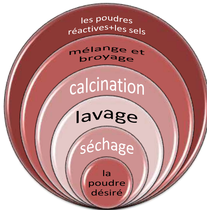
Fig. II.13 : Procédure de préparation dans la synthèse de sel fondu. [Molten Salt]
