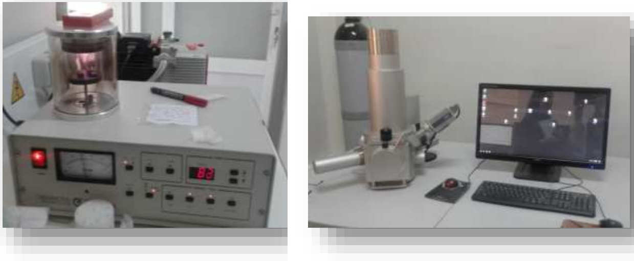
Figure II.19 : présentation de l'appareil de métallisation et l'appareil Microscope électronique à balayage de type TESCAN (VEG A3).
