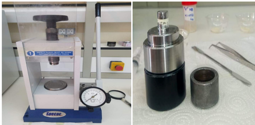
FIGURE II.15 – La presse hydrostatique utilisée pour la préparation des pastilles.
