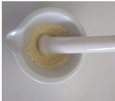
FIGURE II.14 – Rebroyage après la calcination.
