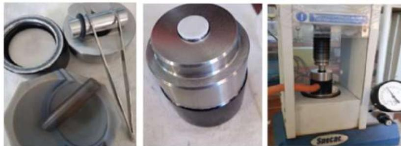
**Figure II.14** : Mortier en agate et presse hydraulique pour préparation des échantillons.
