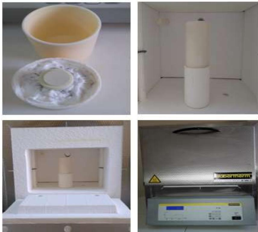
**Figure II. 5 :** Four et dispositif de frittage.
