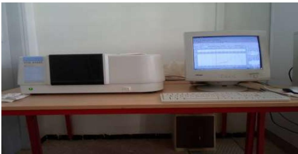
*Figure II.15 : Spectromètre infrarouge à transformée de Fourier FTIR-Shimadzu FTIR-8400.*
