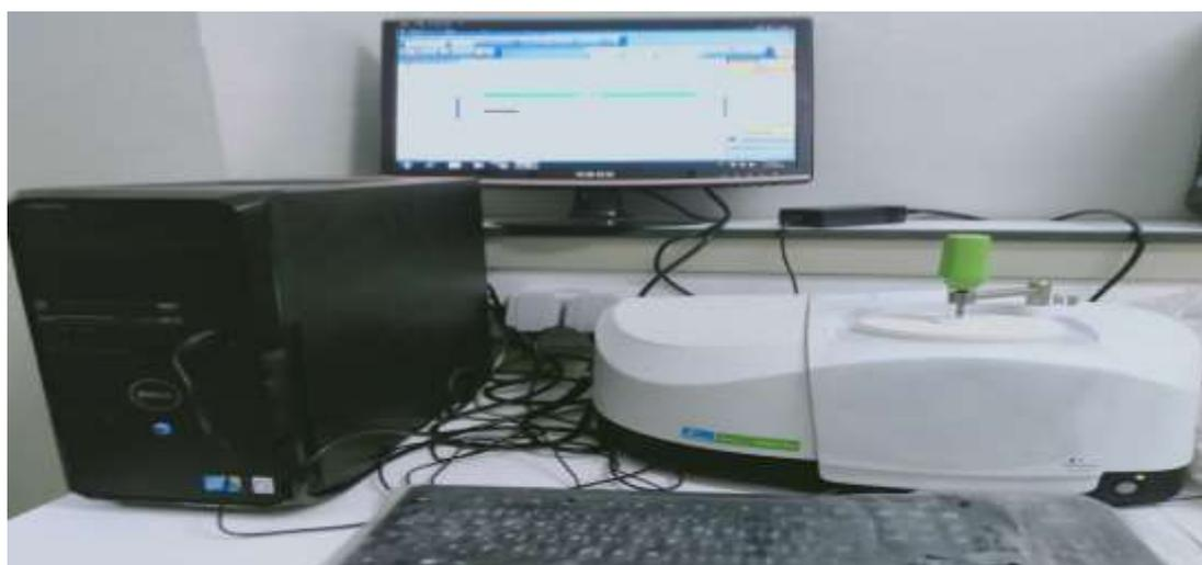
*Figure II. 16 : Spectromètre pour solide de type Perkin Elmer FT-IR.*
