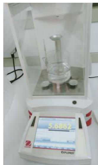
**Figure II.8.** : Balance électrique couplée à l'instrument basé sur la technique de poussée d'Archimède.
