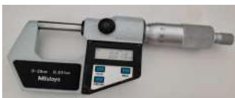
**Figure II.7.** : Micromètre Palmer avec afficheur numérique 0 - 25 mm, Lecture: 0.001 mm DIN .863.1.
