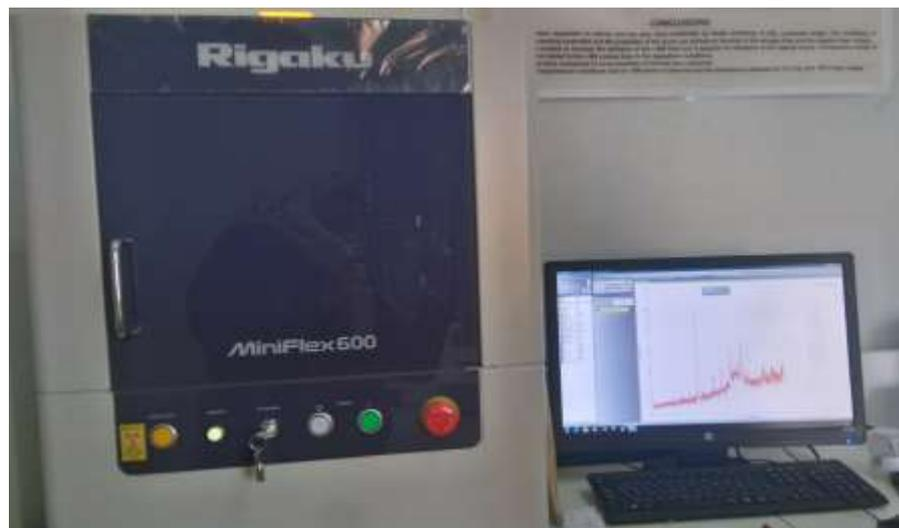
**Figure II.12 :** Diffractomètre Miniflex 600 en configuration Bragg/Brentano dite «  $\theta$ - $\theta$  ».
