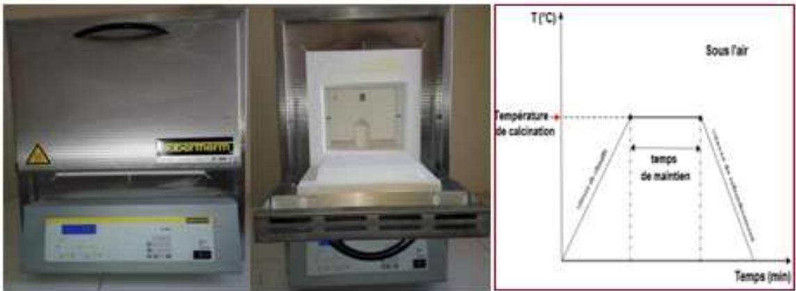
**Figure II.3 :** Four programmable, porte échantillon et schéma de cycle de calcination.
