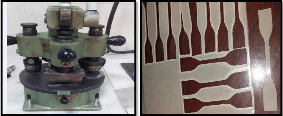
Figure II.11 : Coupure des éprouvettes avec une presse manuelle et une emporte pièces. « L'ENICAB Biskra »
