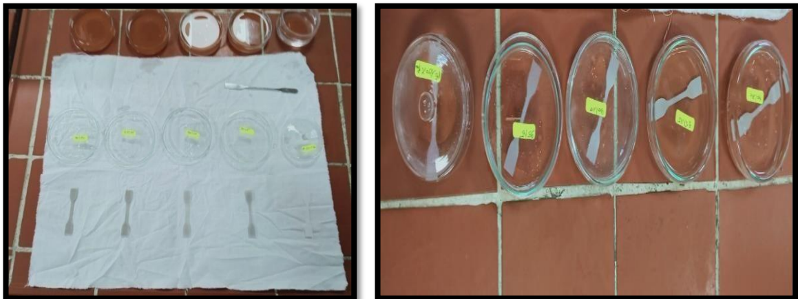
Figure II.14 : Détermination de taux d'absorption de l'eau par les éprouvettes. « L'ENICAB Biskra »
