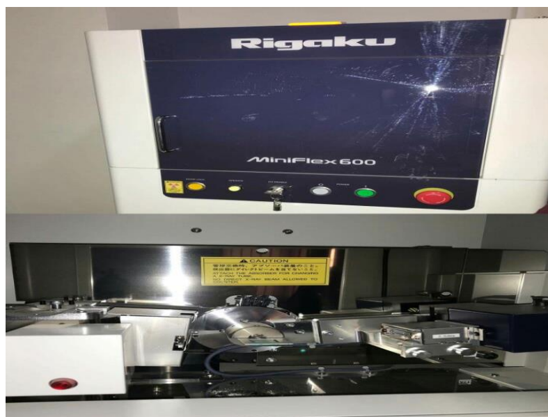
Figure II.5 : L'appareil de la diffraction des rayons X (MiniFlex600 RigaKu).
