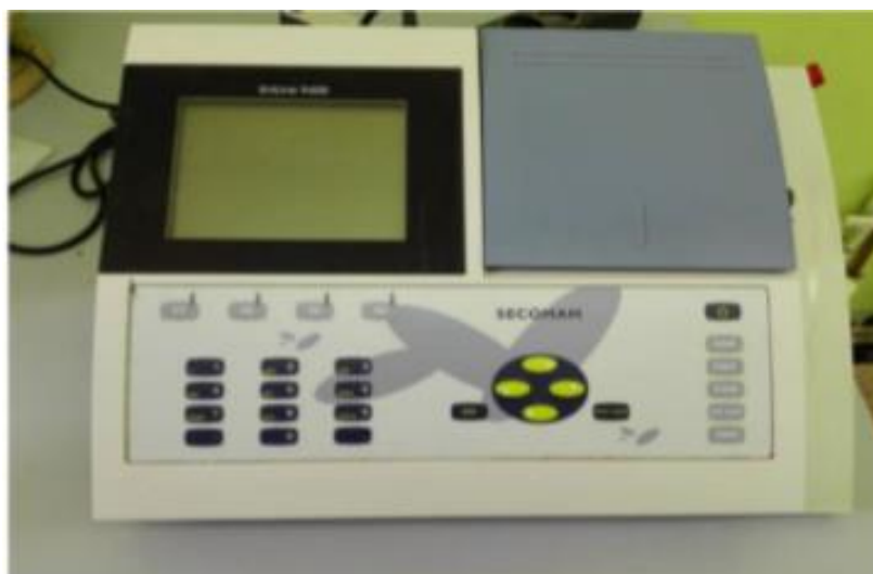
Figure II.10 : Spectromètre UV-visible de type Uviline 9400.
