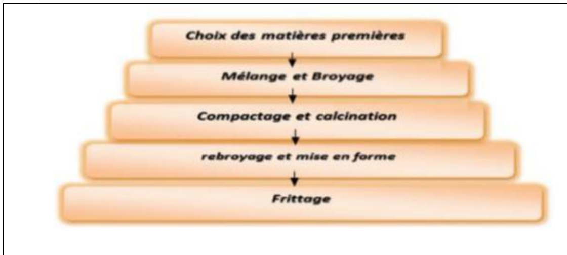
Figure II.1: Organigramme de l'élaboration d'une céramique [07].
