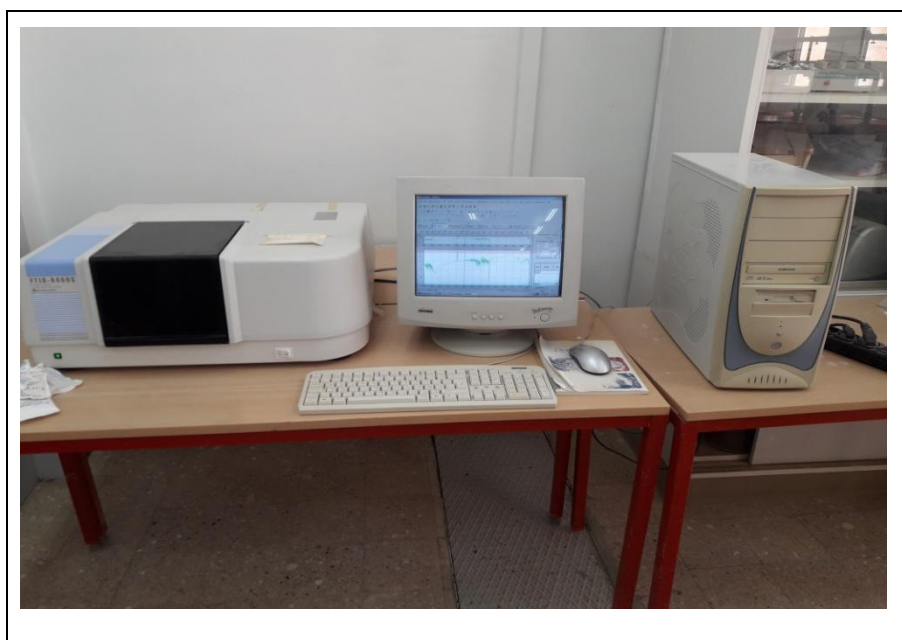
Figure II.16: Spectromètre infrarouge à transformée de Fourier FTIR-Shimadgu 8400S (Personnelle).
