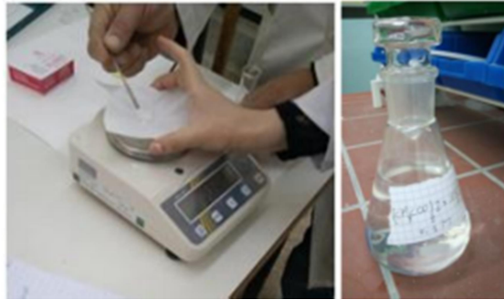
Figure 23: Préparation de la solution acétate de zinc hydraté
