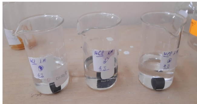
Figure 27: L'acier X70 dans milieu acide HCl sans inhibiteur
