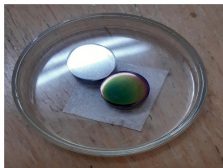
Figure 25: Echantillon avec et sans couche mince
