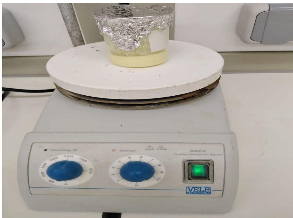
Figure III.2 : Homogénéisation du mélange réactionnel par agitation magnétique.
