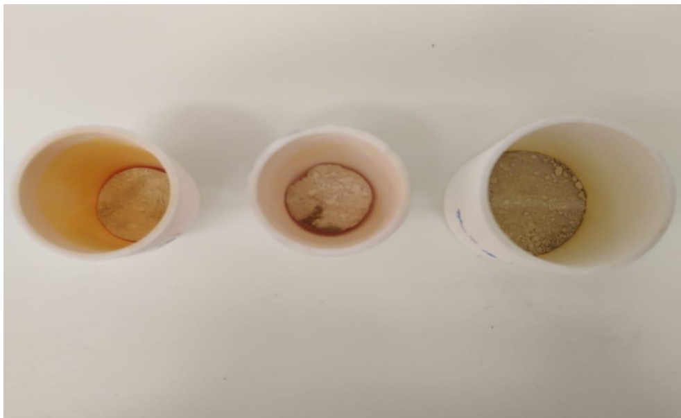
Figure III.8 : Calcination à 1100 ° C.
