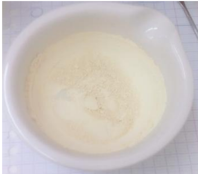
Figure III.7 : Rebroyage par mortier en porcelaine
