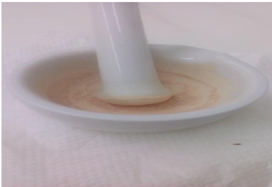
Figure III.4 : Broyage par mortier en porcelaine.
