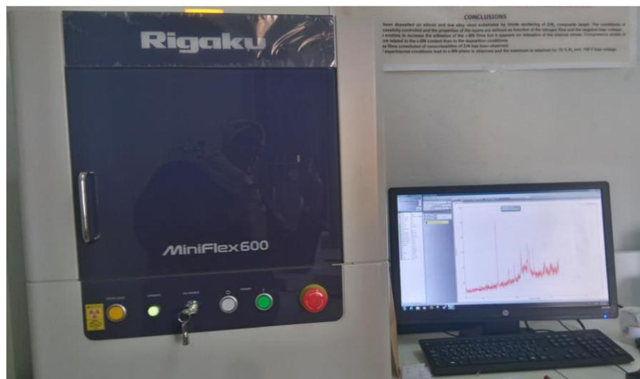
**Figure II.3.1 :** Diffractomètre Miniflex 600 en configuration Bragg/Brentano dite «  $\theta$ - $\theta$  ».
