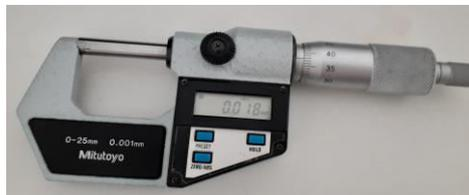
**Figure 3.5. :** Micromètre Palmer avec afficheur numérique 0 - 25 mm, Lecture: 0.001 mm DIN .863.1.
