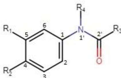
Figure 3.1 : Structure chimique des anilides
