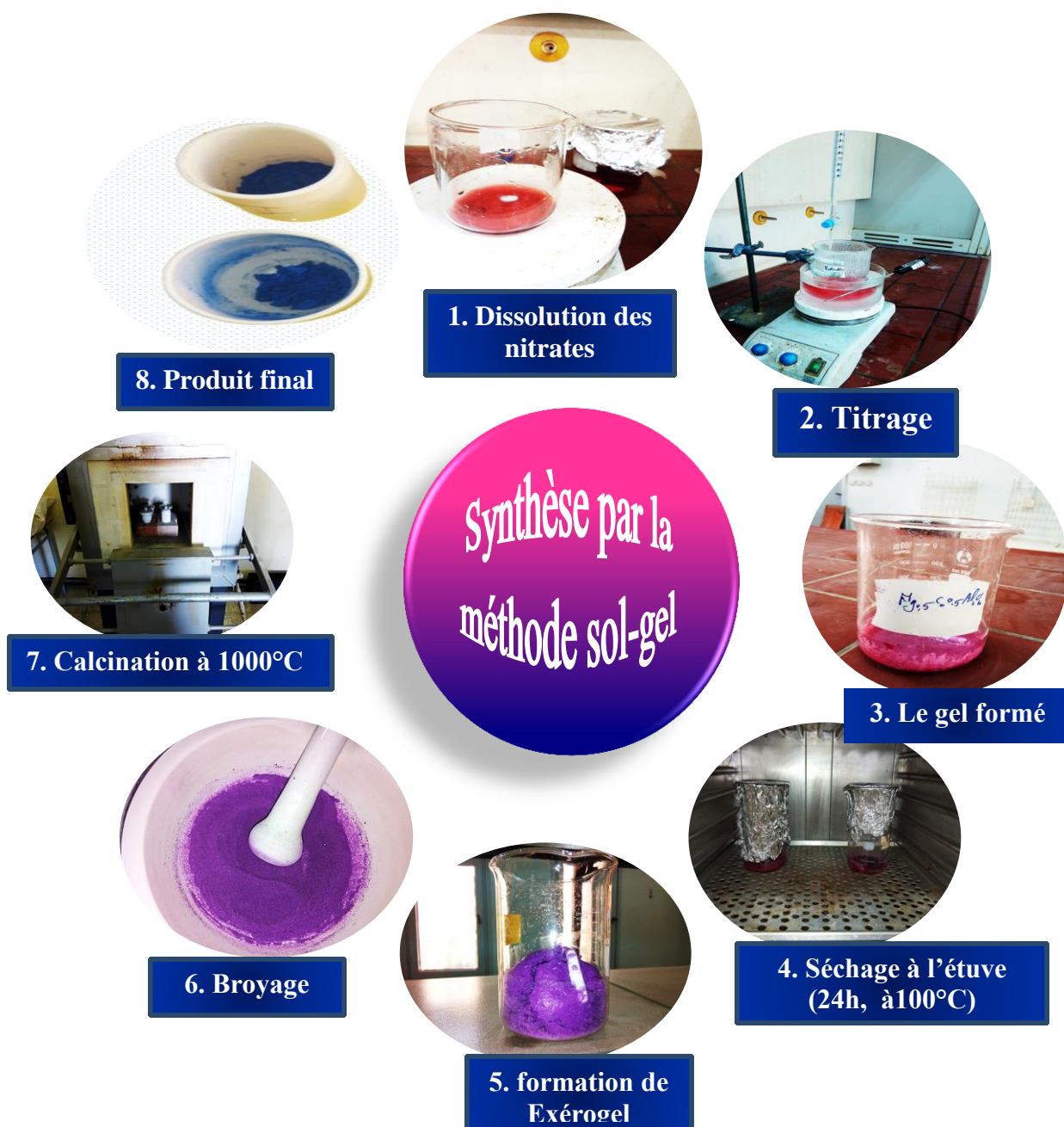
Figure III.1: Les différentes étapes de synthèse des composés Zn_xMg_{0.5-x}Co_{0.5}Al_2O_4 par la méthode sol-gel.
