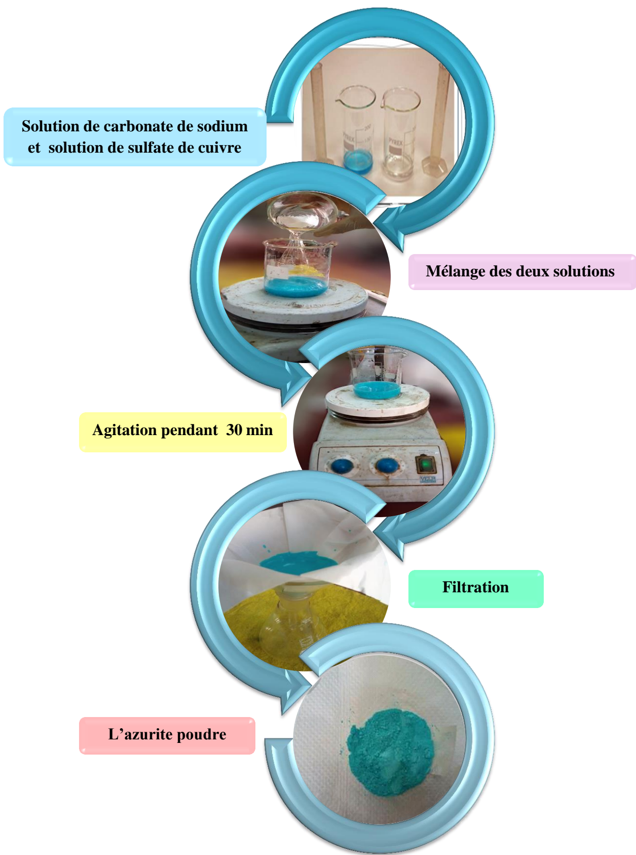
Figure III.13 : Les étapes de synthèse de l'azurite.
