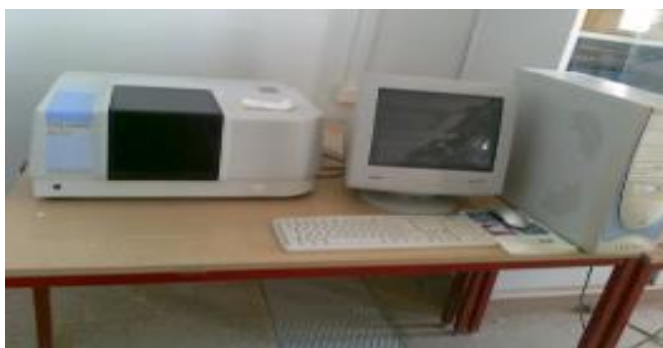
Figure IV.11 : Spectrophotomètre à transformée de Fourier de type SHIMADZU FTIR-8400S(Univ. de BISKRA).
