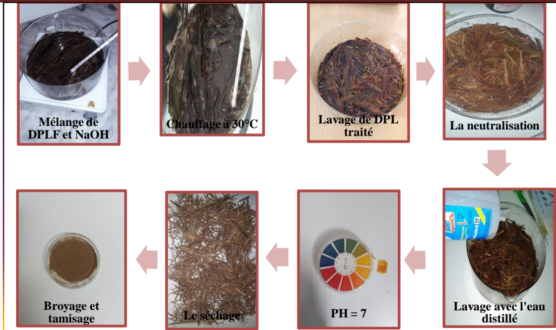
Figure IV.3 : Les étapes de traitement de la fibre DPLF par NaOH.
